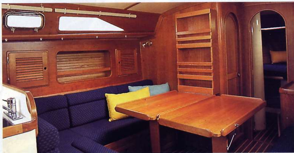
Tutti gli interni sono molto luminosi e ben aerati. Questa è la dinette, che mostra due divani-cuccette contrapposte di cui quella di sinistra diventa doppia; geniale la soluzione del tavolo incernierato sulla paratia, che aperto misura cm 104x110, mentre chiuso scompare del tutto.
