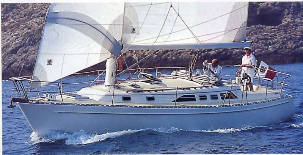
Il rivoluzionario armo del Freedom 38 consiste in un albero di carbonio senza sartie, su cui è inferita una grande randa steccata allunatissima dotata di carrelli e rotaia Harken. Il fiocco autovirante è invece munito di questo boma che serve ingegnosamente a ridurre la catenaria dello strallo.
